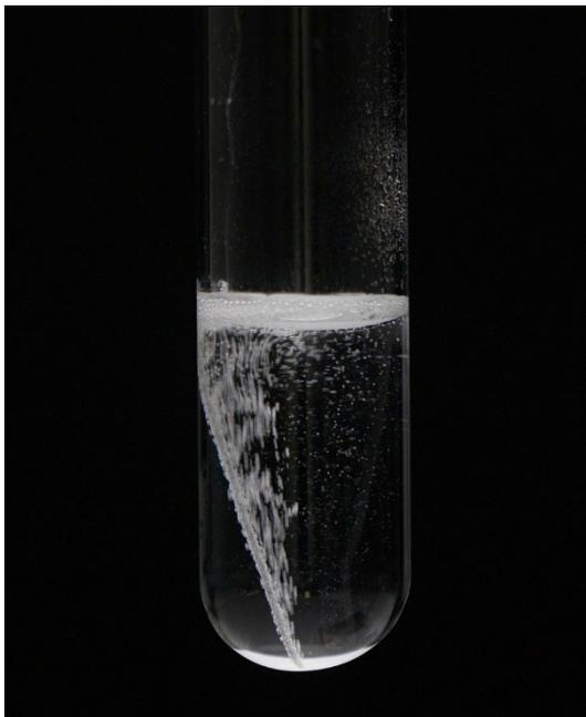
*Abbildung 2: Ein Platindraht als Katalysator für den Zerfall von Wasserstoffperoxid. Entstehender Sauerstoff zeigt, dass die Reaktion bei Raumtemperatur abläuft. Marco Oetken und Dennis Lüke, PH Freiburg.*
