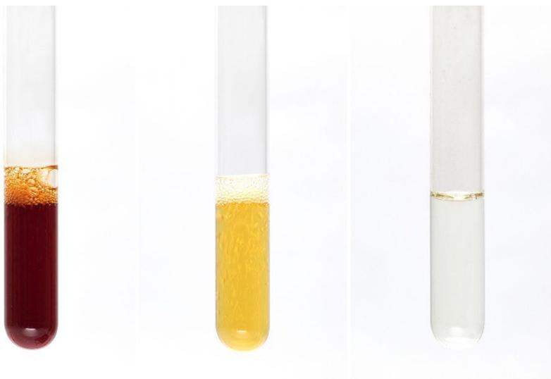
*Abbildung 3: Farbänderungen während des katalytischen Zerfalls von Wasserstoffperoxid durch Molybdat weisen auf temporäre Zwischenverbindungen des katalytischen Reaktionsweges hin. Mit aussetzender Sauerstofffreisetzung ist die Lösung vollständig entfärbt. Marco Oetken und Dennis Lüke, PH Freiburg.*
