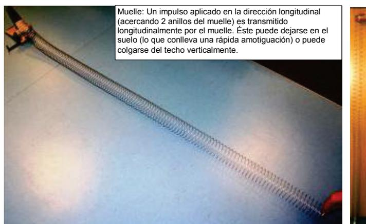
Muelle: Un impulso aplicado en la dirección longitudinal (acercando 2 anillos del muelle) es transmitido longitudinalmente por el muelle. Este puede dejarse en el suelo (lo que conlleva una rápida amortiguación) o puede colgarse del techo verticalmente.
