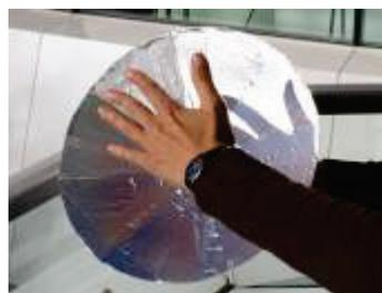
El diámetro del paraboloide construido es de unos 30 cm.
