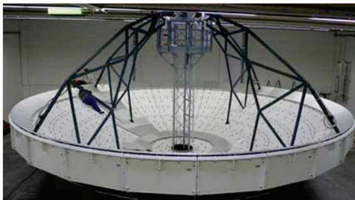
Imagen 3: A la izquierda: modelo de la antena del telescopio ALMA. A la derecha: La antena del telescopio ALMA durante el montaje del panel superficial metálico en la empresa Vertex en Duisburg (Fuente: <http://www.vertexant.com/en/applications/alma.html>, con el amable permiso de Klaus Duespohl, Vertex Antennentechnik).
