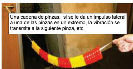
Una cadena de pinzas: si se le da un impulso lateral a una de las pinzas en un extremo, la vibración se transmite a la siguiente pinza, etc.
