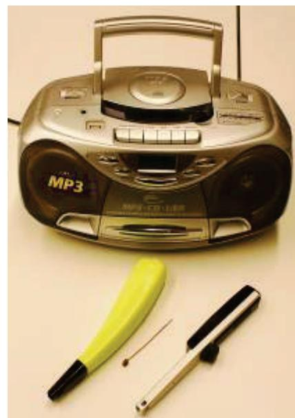
Imagen 9: Las ondas de radio pueden crearse con un encendedor de gas piezo-eléctrico. Su emisión puede mejorarse con una antena de alambre pequeña construida por uno mismo.
