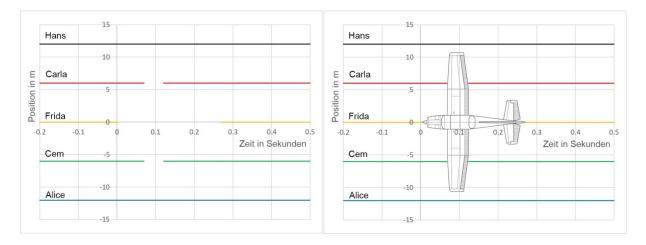
Da die Geschwindigkeit des Flugzeugs bekannt ist, kannst Du die Länge des Flugzeugs und die Breite der Tragflächen berechnen:
