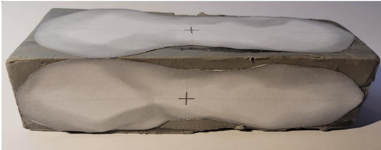
Das Material, das du entfernt hast, formst du wieder zu einem Würfel oder Quader, misst die Seitenlängen ab und bestimmst so das Volumen des entfernten Materials.
