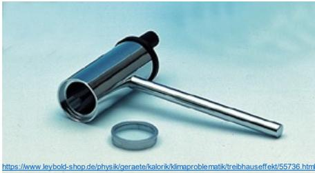
Die Thermosäule nutzt den Temperaturunterschied zwischen dem sich aufgrund der Bestrahlung im Innenraum der Säule erwärmenden Metallplättchen und deren Gehäuse.
