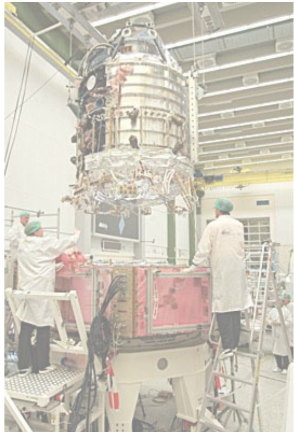
Abb. 7: Kryostat und Servicemodul des Weltraumteleskops HERSCHEL. (Bild: http://www.esa.int/esaSC/SEM0ZJPK6F_index_0.html )
