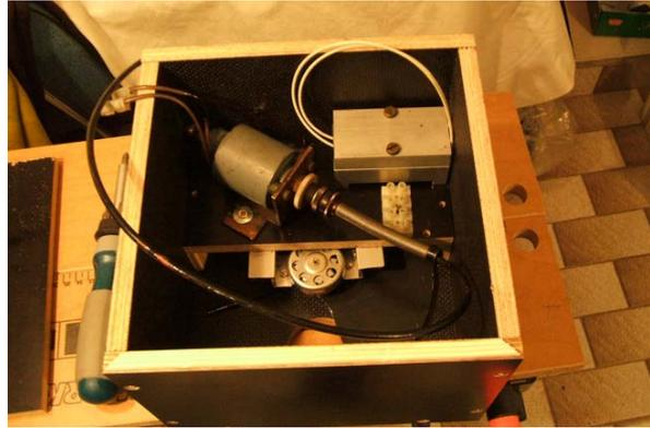
Die Kabel des Shutters müssen durch ein kleines Loch im „Balkon“ auf die Oberseite geführt werden, um den Rotorblättern nicht im Weg zu sein. Dort können sie dann mittels einer Lüsterklemme mit den Kabeln des Fernauslösers und einem Netzkabel verbunden werden, das in einer Ecke des Kastens wieder durch den Balkon nach unten und durch den Kastenboden herausgeführt wird. Alle Kabel sollten wettersicher sein.
