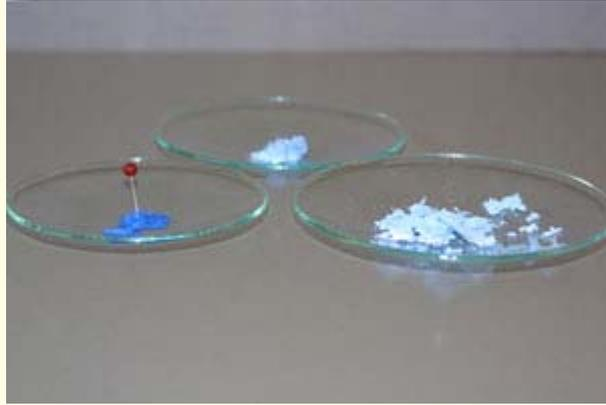
In der Abb. sieht man links die getrocknete Komponente 1: sie ist so zäh, dass eine Stecknadel steht. Die getrocknete Komponente 2 ist faserig und spröde.
