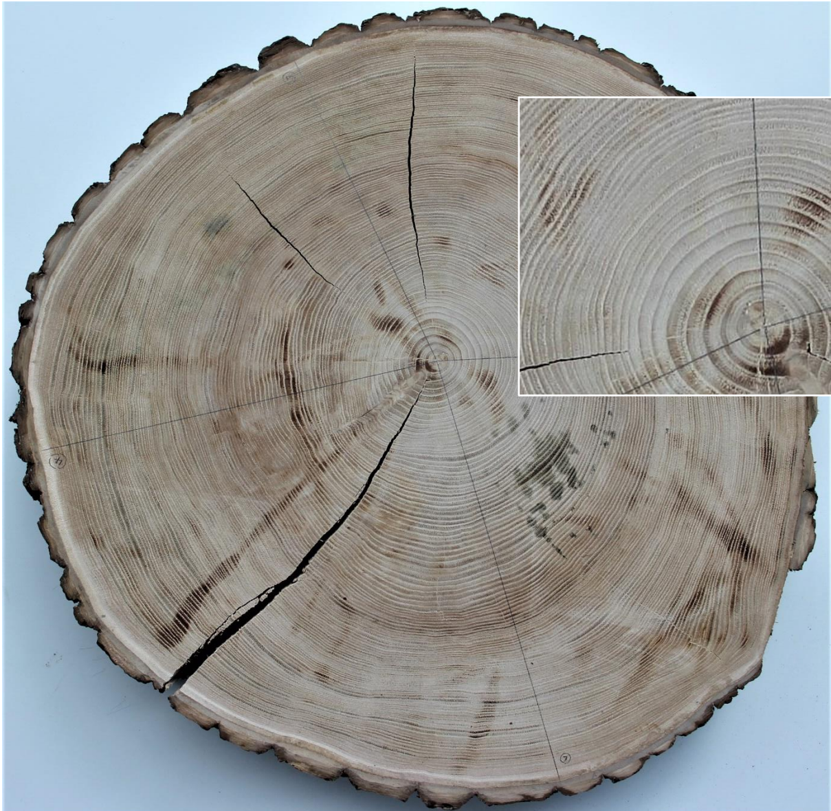
Abbildung 29: Das Bild zeigt die Baumscheibe einer im Forstrevier Heidelberg Ende 2021 gefällten Esskastanie. Für diese Baumscheibe wurden 4 Radien fotografiert, um sie auf vergrößerten Aufnahmen besser vermessen zu können (siehe ‚Anhängende Zusatzmaterialien‘). ©: Olaf Fischer / HdA.
