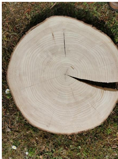
Abbildung 26b: Baumscheiben von Baumarten, deren Kerne nur austrocknen und dabei keine oder nur wenig schützende Gerbstoffe eingelagern. Sie bilden dabei weniger dauerhaft beständiges Reifholz. Von links nach rechts: Aspe (Zitterpappel), Fichte. ©: Olaf Fischer / HdA.
