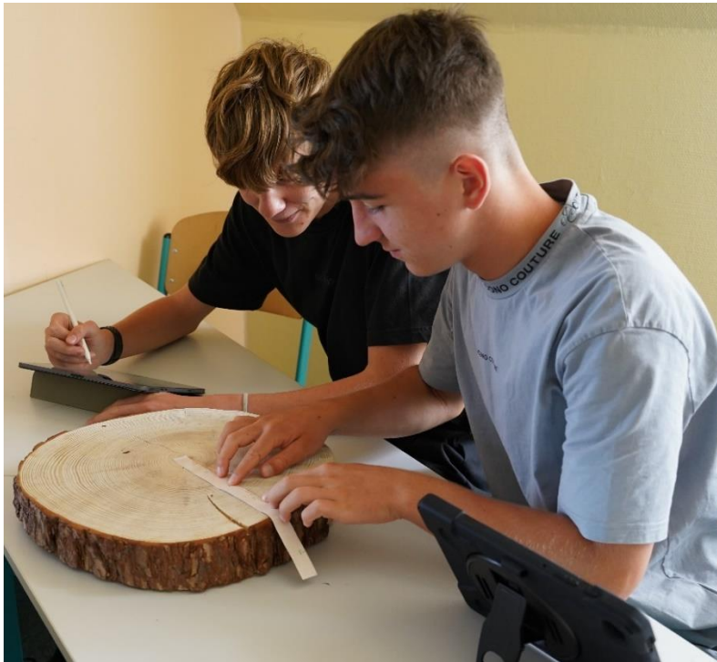
Abbildung 15a: Zwei Schüler übertragen die Messwerte in die vorbereitete EXCEL-Tabelle. Zuvor wurden die Millimeterpapierstreifen mithilfe eines gut gespitzten Bleistifts entsprechend der Jahresringe der Baumscheibe markiert. ©: Ralf Böhm.
