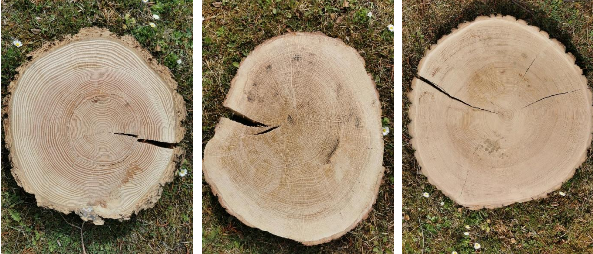
Abbildung 26a: Baumscheiben von Kernholz (dauerhaft beständiges Reifholz) bildenden Baumarten. Oben von links nach rechts: Douglasie, Eiche, Esskastanie. Unten: Kiefer. ©: Olaf Fischer / HdA.
