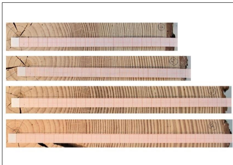
Abbildung 4b: Vorder- und Rückseite der Bildvorlage von einer Baumscheibe (Gesamtansicht, vier Teilbilder von Radiusbereichen). Die Bilder können auf A4 oder A3 vergrößert ausgedruckt und laminiert werden. Die ebenfalls abgebildete (mitvergrößerte) Millimeterskala erleichtert die Auswertung indem man mit einem Fineliner direkt auf den laminierten Bildern die Ringe markiert (später wieder abwischbar).
