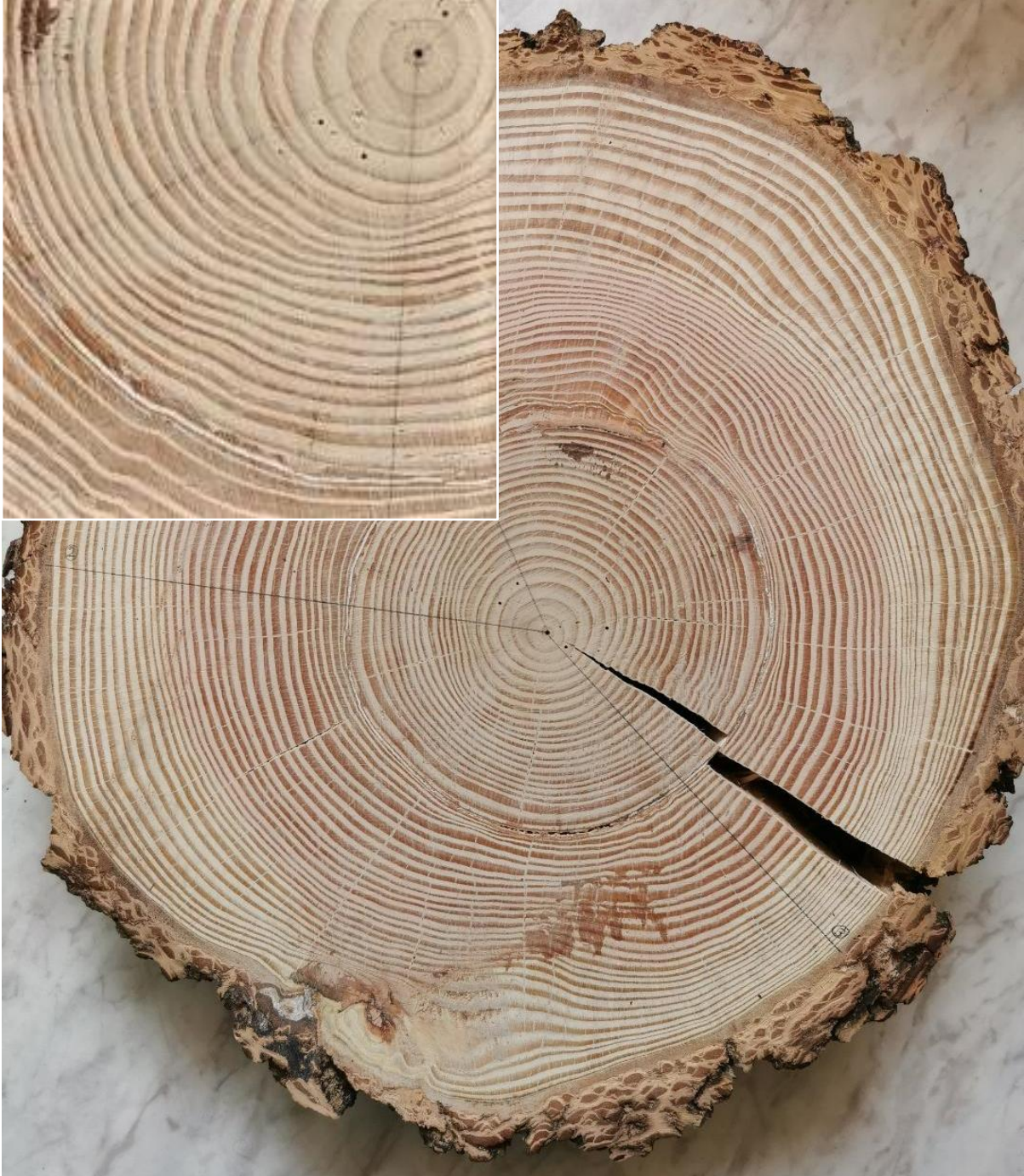
Abbildung 27: Das Bild zeigt die Baumscheibe einer im Forstrevier Heidelberg im November 2021 gefällten Douglasie. Für diese Baumscheibe wurden 4 Radialen fotografiert, um sie auf vergrößerten Aufnahmen besser vermessen zu können (siehe ‚Anhängende Zusatzmaterialien‘).
