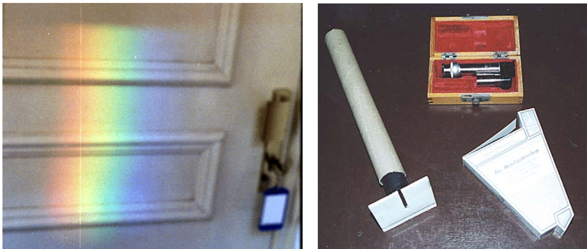
Abbildung 2: Links: Spektren begegnen uns im Alltag öfters. Das an der Kante der gläsernen Brüstung eines einige Meter entfernten Balkons gebrochene Sonnenlicht erzeugt ein eindrucksvolles Spektrum an der Zimmertür. Rechts: Ein professionelles und zwei selbst gefertigte Handspektroskope zur Freihandbeobachtung der Spektren heller Lichtquellen. Es handelt sich hierbei durchweg um Spaltspektroskope. Unten links: Handspektroskop mit Geradsichtprisma und Spalt aus zwei Rasierklingen (siehe [3]). Unten rechts: Handspektroskop mit Gitter. Der preiswerte Selbstbausatz ([2]) erlaubt die Herstellung eines Klassensatzes von Handspektroskopen. Eine Wellenlängenskala erlaubt dabei sogar quantitative Aussagen.
