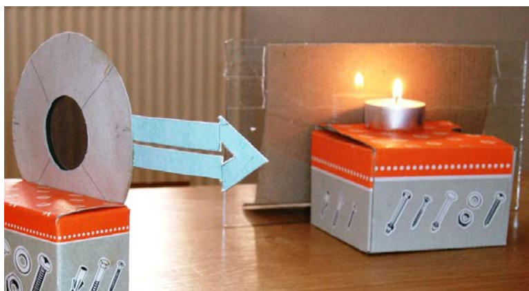
Abbildung 5: Das Licht einer Kerze spiegelt sich teilweise an einer senkrecht stehenden Glasplatte. Bei Blick durch einen Polarisationsfilter (links, Schulausrüstung) kann man das gespiegelte Bild „auslöschen“, wenn das Licht unter dem Brewsterwinkel auf die Glasplatte fällt und wenn die Durchlassrichtung des Polarisationsfilters (angedeutet durch Pfeil) senkrecht zur Schwingungsrichtung der reflektierten Wellen steht (siehe auch Abb. 6).
