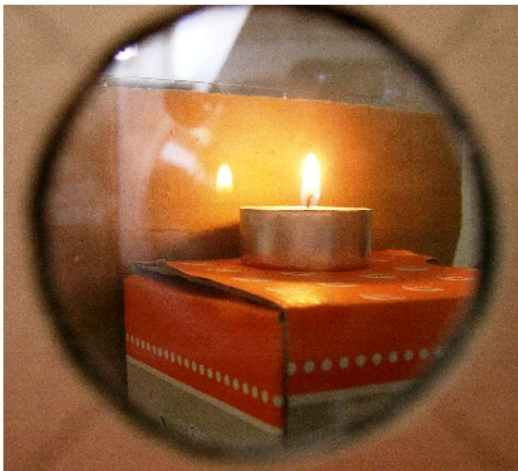
Abbildung 6: Links: Vom reflektierten Licht der Kerze ist trotz „Sperrrichtung“ des Polarisationsfilters noch etwas zu sehen, weil das Licht nicht vollständig polarisiert ist. Rechts: Bei einem Lichteinfall von etwa 60^\circ (Brewsterwinkel von normalem Glas: 57,2^\circ ) ist vom reflektierten Licht nichts mehr zu sehen. Polarisationsfilter werden bei der Fotografie genutzt, um Reflexe zu reduzieren, was nicht mit der Reflexminderung durch \lambda/4 -Schichten auf Linsen zu verwechseln ist. ©: Olaf Fischer.
