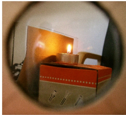
Abbildung 6: Links: Vom reflektierten Licht der Kerze ist trotz „Sperrrichtung“ des Polarisationsfilters noch etwas zu sehen, weil das Licht nicht vollständig polarisiert ist. Rechts: Bei einem Lichteinfall von etwa 60^\circ (Brewsterwinkel von normalem Glas: 57,2^\circ ) ist vom reflektierten Licht nichts mehr zu sehen. Polarisationsfilter werden bei der Fotografie genutzt, um Reflexe zu reduzieren, was nicht mit der Reflexminderung durch \lambda/4 -Schichten auf Linsen zu verwechseln ist. ©: Olaf Fischer.
