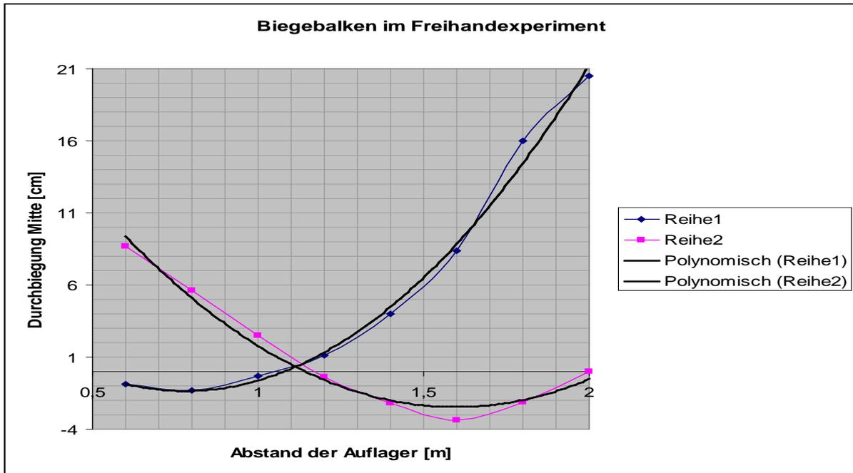
Die minimale Durchbiegung liegt dort, wo sich die Trendlinie für Reihe 1 (Mitte) mit der Trendlinie für Reihe 2 (Enden) schneidet, d. h. bei etwa 1,12. Das sind 56 %. Als Abschätzung ist dieses Ergebnis vertretbar.
