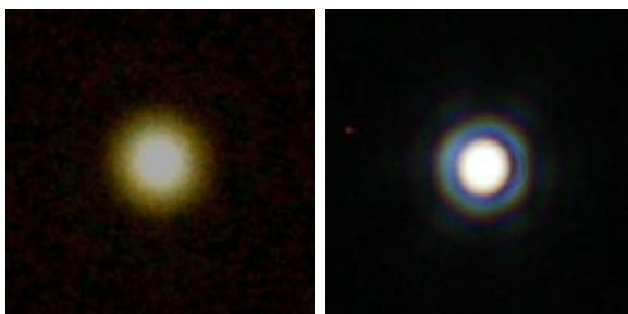
Abbildung 21: Beugung an Kreisblenden (Lochblenden) mit Durchmessern von etwa 2 mm und 6 mm. ©: Olaf Fischer.
