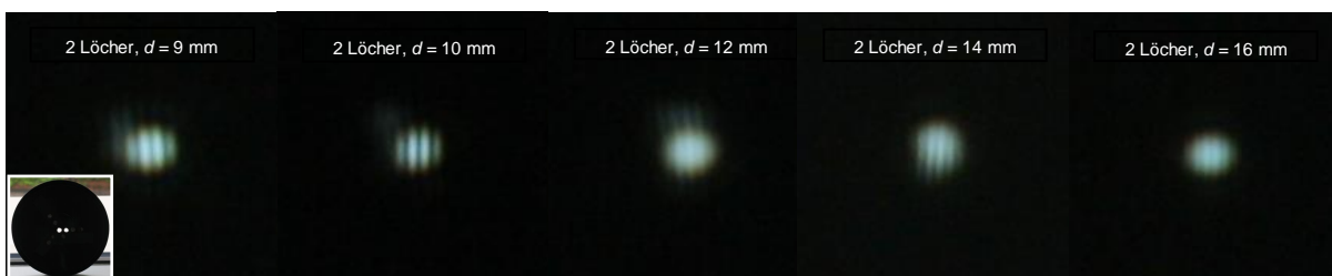
Abbildung 26: Interferenzmuster des Modell-Doppelstern nach einer Doppellochaperatur mit verschiedenen Lochabständen. ©: Olaf Fischer.
