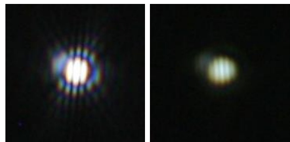
Abbildung 22: (Beugung und) Interferenz an Doppellochblenden (Durchmesser: 6 mm) mit Lochabständen von ca. 1 cm und 1,2 cm. ©: Olaf Fischer.
