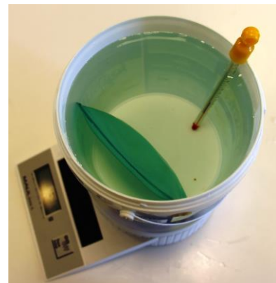
Abbildung 4: Links: Bestimmung der Masse der Natriumacetat-Trihydrat-Flüssigkeit (Masse des Beutels wird vernachlässigt). Rechts: a.) Bestimmung der Wassermasse (unter Abzug der Massen von Becher, Beutel und Thermometer) und der Ausgangstemperatur. b.) Bestimmung der Endtemperatur einige Minuten nach Kristallisation. © Verfasser
