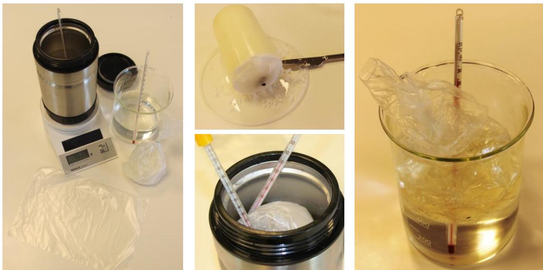
Abbildung 7: Experiment zur Bestimmung der spezifischen Schmelzwärme (= Erstarrungswärme) von Paraffin. Links: Hilfsmittel für das Experiment, Mitte oben: Das Paraffin wird von einer großen Kerze abgeschnitten, Mitte unten: Die Mischungstemperatur ist dann erreicht, wenn das Thermometer im Wasser die gleiche Temperatur wie das dicht am Paraffinblock anliegende Thermometer anzeigt, rechts: Das Paraffin im Folienbeutel wird im heißen Wasserbad geschmolzen. © Verfasser
