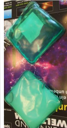
Abbildung 3: Links: Handwärmer im Zustand der unterkühlten Schmelze. Im Beutel ist das metallische Klick-Blättchen zu sehen, welches zum Auslösen der Kristallisation durch stoßartige Erschütterung beim Klicken dient. Rechts: Die im flüssigen Zustand durchsichtige Schmelze ist im kristallisierten Zustand nicht mehr durchsichtig. © Verfasser
