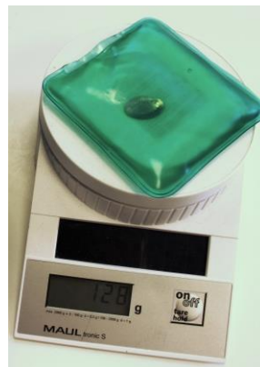
Abbildung 4: Links: Bestimmung der Masse der Natriumacetat-Trihydrat-Flüssigkeit (Masse des Beutels wird vernachlässigt). Rechts: a.) Bestimmung der Wassermasse (unter Abzug der Massen von Becher, Beutel und Thermometer) und der Ausgangstemperatur. b.) Bestimmung der Endtemperatur einige Minuten nach Kristallisation. © Verfasser
