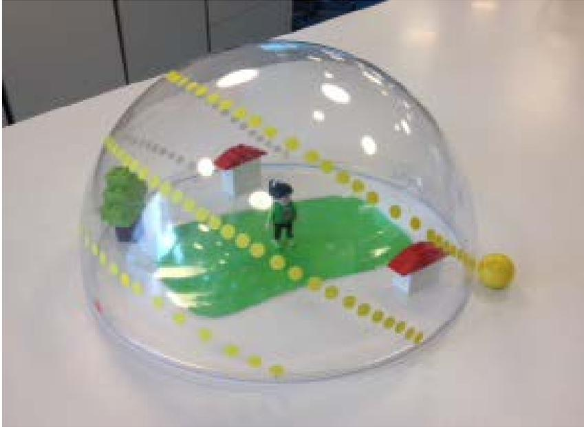
Abbildung 11: Horizontmodell mit den drei unterschiedlichen Sonnenbahnen (12.12., 21.3./23.9. und 21.6.).
