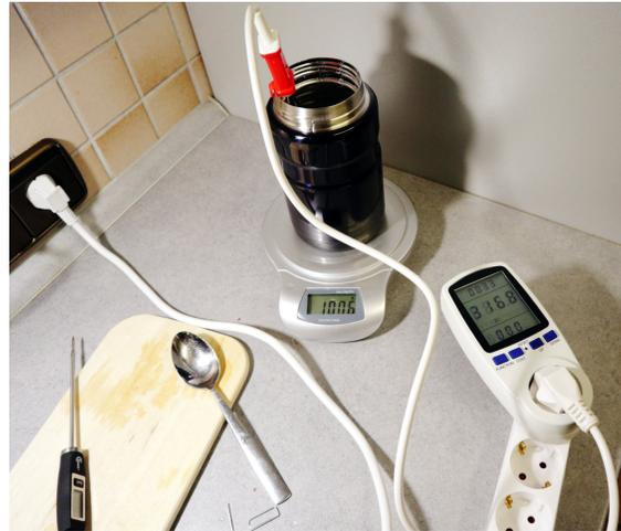
Abbildung 7: Versuchsaufbau für die Messung der Wärmekapazität von Wasser. Von links nach rechts: elektronisches Thermometer, Löffel zum Umrühren, Thermosgefäß mit Tauchsieder, elektrisches Leistungsmessgerät. Bild: Markus Pössel.
