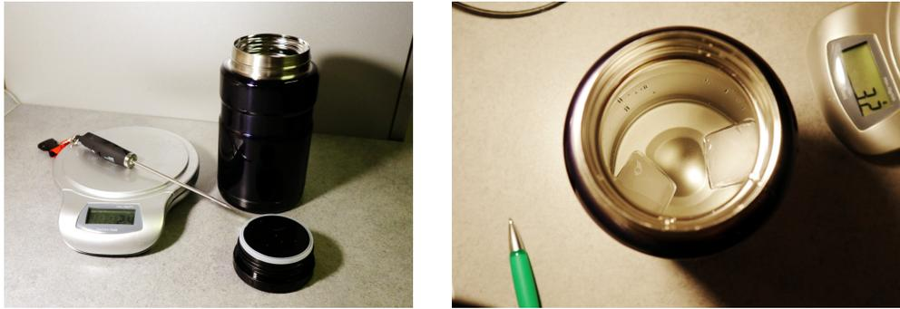
Abbildung 5: Zubehör für die Bestimmung der Schmelzwärme von Eis. Bilder: Markus Pössel.
