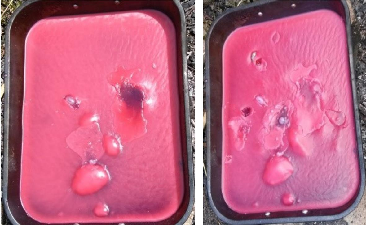
Abbildung 2: Links: Oberflächenstrukturen nach drei Einschlägen unterschiedlich großer Steine. Rechts: nach vier weiteren Einschlägen kleinerer Objekte; die beiden Aufwölbungen am unteren Bildrand zeigen zeitliche Veränderungen. ©: J. Wallasch.
