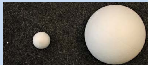
3 Styroporkugeln (d = 2 mm, 5 cm und 15 cm) für den Fallversuch
