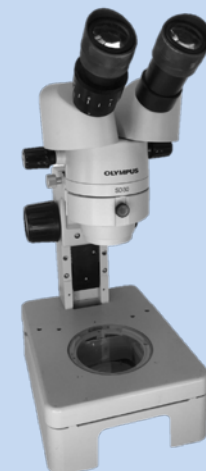
Binokulares Mikroskop mit bis zu etwa 70-facher Vergrößerung. ©: Sarah Greenwood - Eigenes Werk, CC BY-SA 4.0, https://commons.wikimedia.org/w/index.php?curid=71630776
