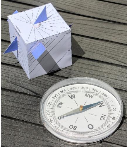
Bei der Nutzung der Würfelsonnenuhr ist zu beachten, dass diese gut horizontalisiert und exakt in Nord-Süd-Richtung ausgerichtet aufgestellt wird. Dies garantiert, dass die maßgeblichen Schattenwerfer-kanten alle in Richtung zu den Himmelspolen weisen und die Uhr entsprechend gut funktioniert. Ein Kompass kann bei der Ausrichtung helfen, wobei man aber wissen sollte, dass der magnetische Nordpol nicht dem geografischen Nordpol entspricht (der Unterschied spielt hier aber keine Rolle).
