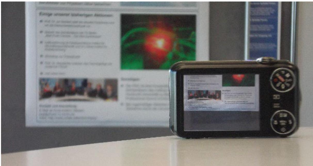
**Abbildung 2:** Unsere einfache Digitalkamera hat bei 5-fach Zoom ein Sichtfeld von ungefähr  $15^\circ$  Breite, d. h. bei einer gerade noch abgebildeten Gegenstandsweite von 84 cm ist die Kamera etwa 320 cm vom Gegenstand entfernt. ©: UniLab Adlershof.
