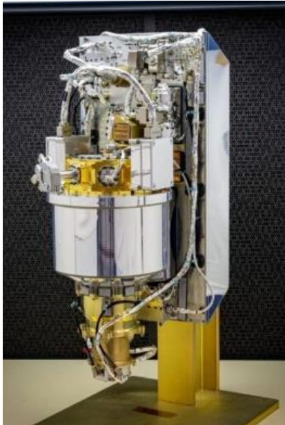
Abbildung 6: Psyches Gammastrahlen- und Neutronenspektrometer. © Johns Hopkins APL/Ed Whitman.
