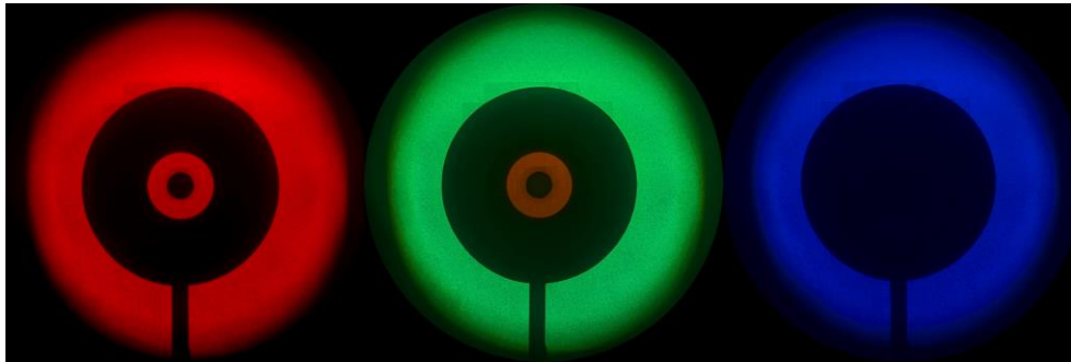
Abbildung 2.6: Demonstrationsversuch zur Bedeckung eines Sterns durch einen vorbeiziehenden Planeten mit einer Atmosphäre. Der dunkle Kreis in der Mitte bedeckt den Lichtfleck im Hintergrund, wie ein Planetenkörper einen Stern teilweise verfinstern würde. Die Atmosphäre wurde mit einem roten Farbfilter realisiert, der den blauen Anteil des Lichts blockiert und sich zwischen dem „Planet“ und der Halterung befindet. Die Atmosphäre erscheint bei der Beobachtung mit verschiedenen Farbfiltern unterschiedlich stark verdunkelt. Dadurch erscheint die Atmosphäre im linken Fall transparent, weil die Kamera die Anordnung mit einem Rotfilter beobachtet. Mit anderen Filtern erscheint der Bereich unterschiedlich stark abgeschwächt. Dieser Vorgang kann während eines tatsächlichen Planetentransits nicht beobachtet werden. Er wird nur indirekt durch die Abnahme der Sternhelligkeit wahrgenommen. Die ringförmige Halterung um die zentrale Scheibe muss vernachlässigt werden. (Bild: M. Nielbock, Lizenz: CC BY 4.0 )
