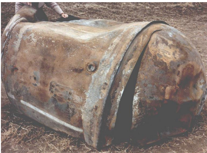
Abbildung 3 – Haupttreibstofftank einer Delta 2 Rakete, der am 22. Januar 1997 nahe Georgetown (USA) auf der Erde aufschlug (Quelle: NASA, Lizenz: gemeinfrei).
