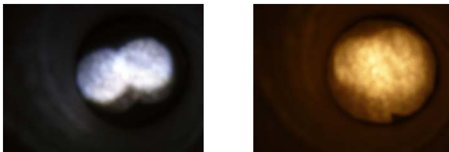
Abbildung 6: Wenn die Lichtstrahlen erst eine Blende mit großem Loch passieren müssen („Objektiv“ mit großer Öffnung), bevor sie in eine Lochkamera gelangen, kommt eine Abbildung zustande. Sie ist jedoch sehr unscharf. Links: Die beiden LEDs einer Stirnlampe werden als große, unscharfe Flecken abgebildet. Rechts: Bei einer Lampe mit Glühbirne und strukturiertem Lampenschirm aus Glas wird der Projektionsschirm zwar großflächig, aber nur ungleichmäßig ausgeleuchtet. Das lässt erahnen, dass der Lampenschirm Strukturen haben muss. (Bilder: Monika Maintz)
