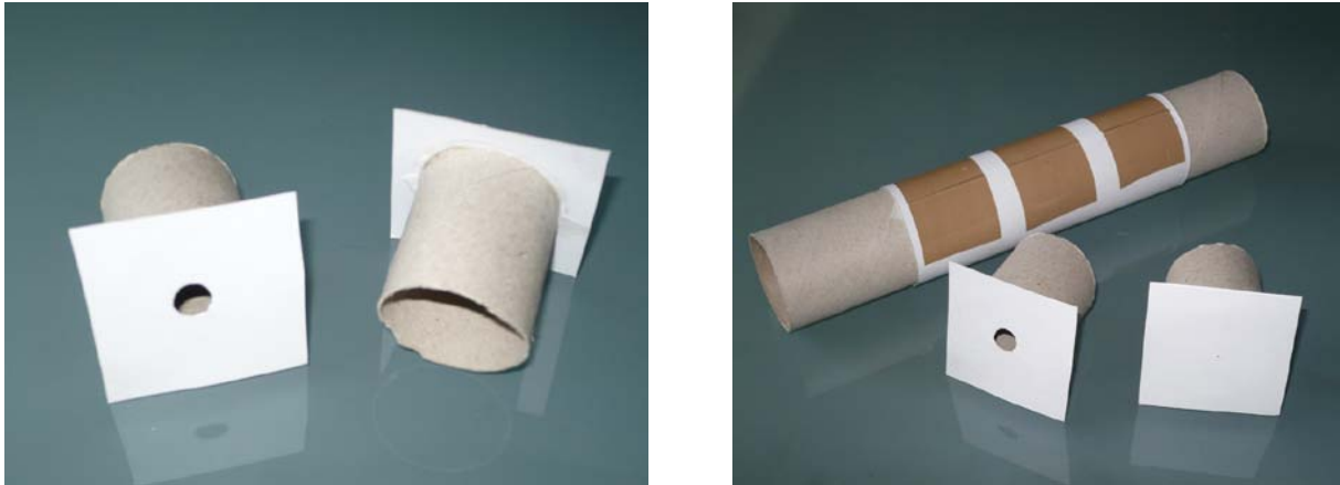
Abbildung 3: Links: „Objektive“ für die Lochkamera mit unterschiedlichen Blendenöffnungen. Rechts: Einzelteile der Lochkamera: Pappröhr mit eingebautem Projektionsschirm und „Objektive“. (Bilder: Monika Maintz)
