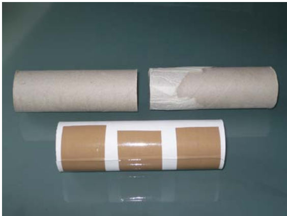
Abbildung 2: Einzelne Teile, aus denen die Lochkamera zusammengebaut wird: Links: In zwei Teile geschnittenes Innenrohr (hinten) und Außenrohr (vorne). Rechts: Das Butterbrotpapier, das eines der beiden Teilrohre des Innenrohrs verschließt, dient als Schirm, auf dem die zu beobachtenden Gegenstände abgebildet werden. (Bilder: Monika Maintz)
