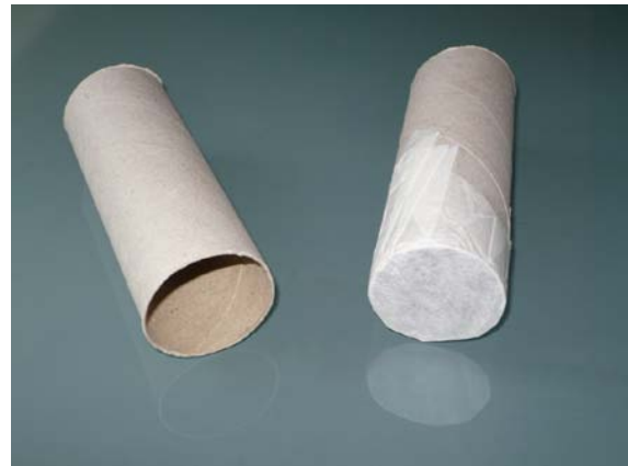
Abbildung 2: Einzelne Teile, aus denen die Lochkamera zusammengebaut wird: Links: In zwei Teile geschnittenes Innenrohr (hinten) und Außenrohr (vorne). Rechts: Das Butterbrotpapier, das eines der beiden Teilrohre des Innenrohrs verschließt, dient als Schirm, auf dem die zu beobachtenden Gegenstände abgebildet werden. (Bilder: Monika Maintz)
