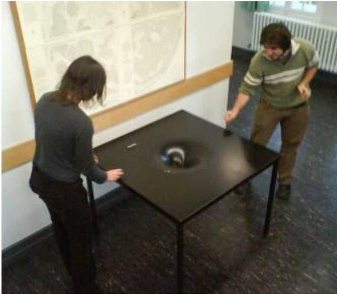
Modelle für Potentialtrichter können auf vielfältige Weise hergestellt werden. Im einfachsten Fall spannt man einen Müllsack oder ein dehnbare Gewebe über einen Holzrahmen und beschwert die Stelle, die das Gravitationszentrum darstellen soll, mit einem Gewicht, etwa einer Stahlkugel.
