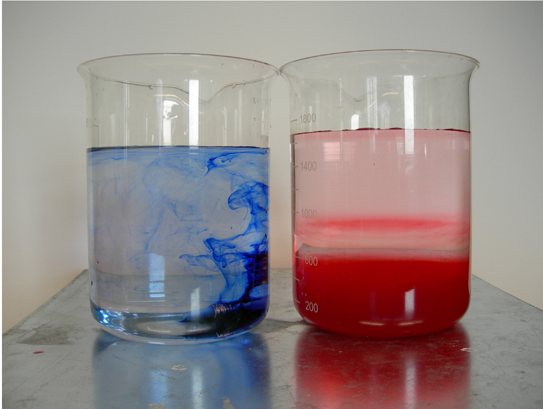
Abb. 3: In der linken Flüssigkeit kommt es zu einer ausgeprägten Konvektion. Die Salzwasserschichtung rechts ist gegen Konvektion stabil.
