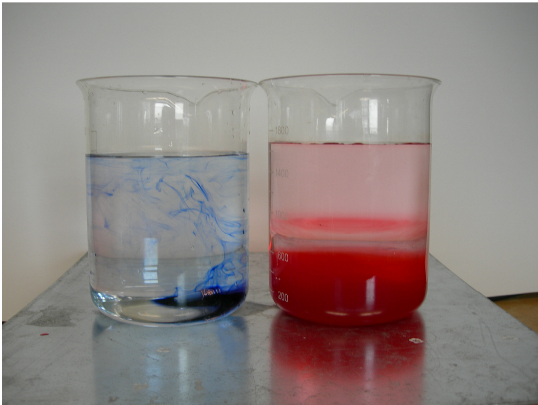
Abb. 2: Einsetzende Konvektion im Wassergefäß
