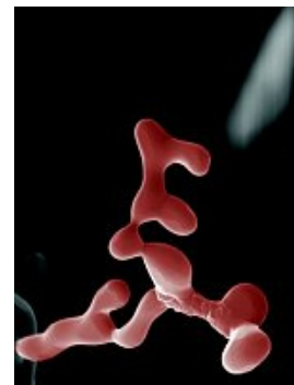
Beim plötzlichen Gefrieren der Probe werden einzelne keramische Partikel in den wachsenden Eiskristallen gefangen. Dadurch entstehen kuriose Figuren.
