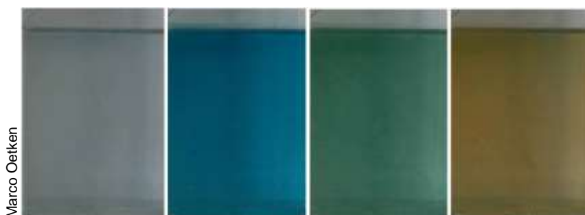
Abb. 7: Von links nach rechts: weißes \text{K}_2\text{Fe}^{\text{II}}[\text{Fe}^{\text{II}}(\text{CN})_6] ; blaues \text{KFe}^{\text{II}}[\text{Fe}^{\text{III}}(\text{CN})_6] ; grünes [\text{Fe}^{\text{III}}_3\{\text{Fe}^{\text{III}}(\text{CN})_6\}_2\{\text{Fe}^{\text{II}}(\text{CN})_6\}] und braunes [\text{Fe}^{\text{III}}\text{Fe}^{\text{III}}(\text{CN})_6] auf einem FTO-Glas in wässriger Kaliumnitrat-Lösung.
